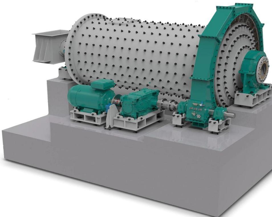
Шаровые мельницы CENTERCONE обеспечивают высокую эффективность измельчения благодаря оптимизированной геометрии барабана, усиленным подшипникам и надежному зубчатому приводу.
