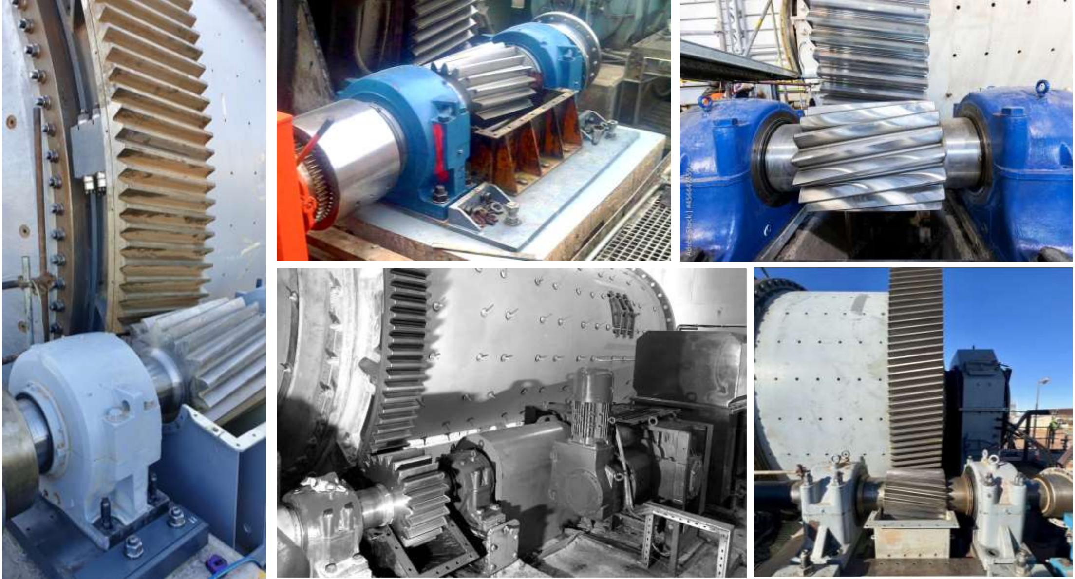
Şekil 01. Yenilenmiş Pinyon Dişliler
